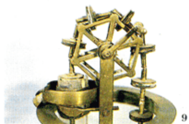
7-Microscopio monoculare costruito nel 1865 dai fratelli Beck di Londra. 8-Macchina elettromagnetica (macchinetta) di Antonio Pacinotti risalente alla fine del secolo scorso: prototipo della dinamo, consentiva la trasformazione reciproca della energia elettrica e di quella meccanica. Pacinotti, docente della facoltà di Agraria di Pisa, non sfruttò commercialmente la geniale intuizione. 9-Particolare di un modello di noria per il sollevamento dell'acqua. 10-Diploma di onore del concorso a premi di vini, oli, enotecnica e oleificio assegnato nel 1886 ad Antonio Pacinotti. 11-Appunti manoscritti di Antonio Pacinotti sulla vinificazione (1885). Per documentarsi nel campo della enologia, Pacinotti studiò approfonditamente le opere di Pasteur
